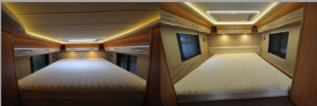
Das absenkbares Bett über der Heckgarage sorgt für optimale Raumnutzung
